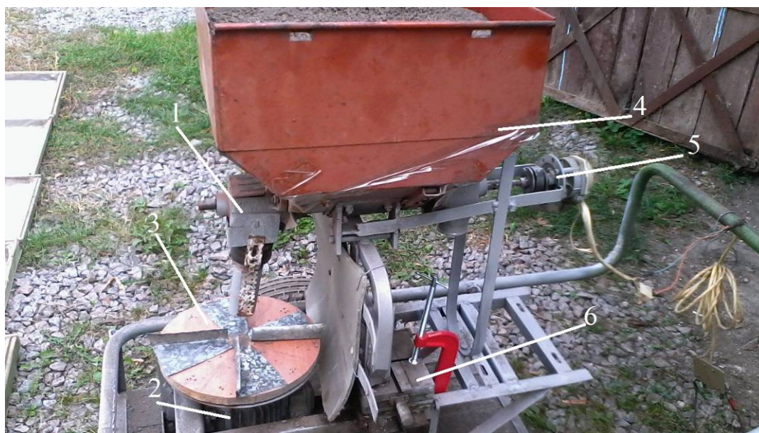
Рисунок 2 – Лабораторная установка центробежного рабочего органа: 1 – питатель; 2 – электродвигатель привода рабочего диска; 3 – распределяющий орган; 4 – бункер; 5 – электродвигатель привода питателя; 6 – устройство изменения места подачи на диск
