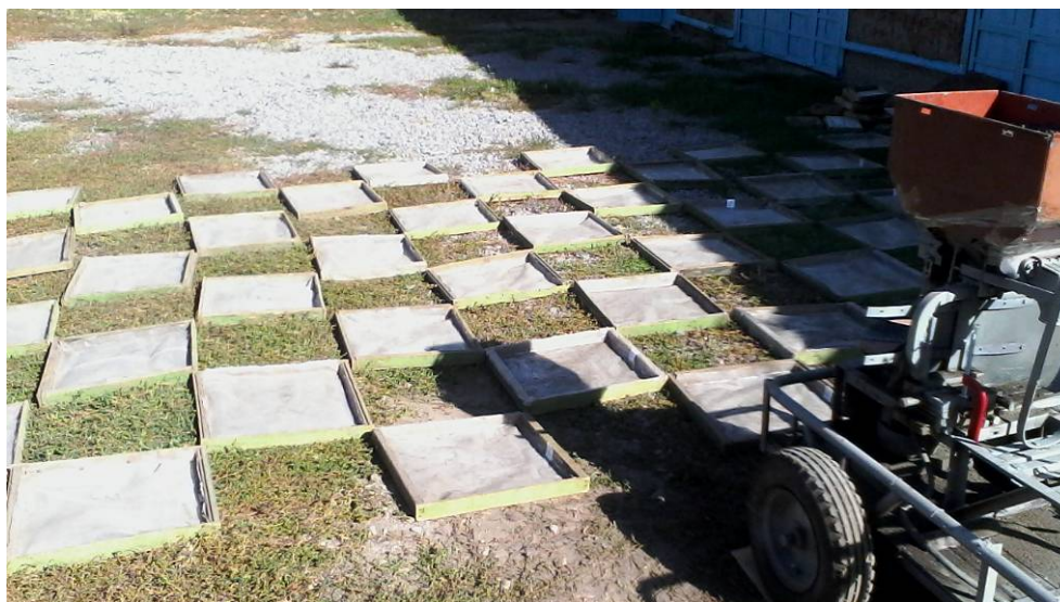
Рисунок 3 – Схема установки поддонов для сбора опытных данных
