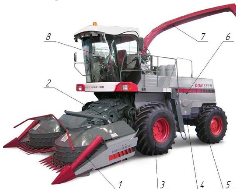
Рисунок 1 - Кормоуборочный комбайн «Дон-680М»: 1 – адаптер; 2 – рабочие узлы; 3 – ведущие колёса; 4 – рама; 5 – управляемые колёса; 6 – двигатель; 7 – силосопровод; 8 – кабина
