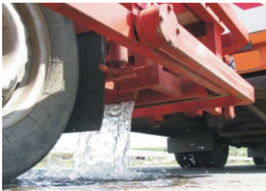
Рисунок 6 - Увлажнение поверхности при измерении коэффициента продольного сцепления установкой ПКРС – 2У
