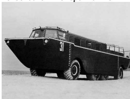
Рисунок 6 - Плавающая колесная машина ЗИЛ-155П с несущим (безрамным) корпусом из ПКМ (впервые в мире)
