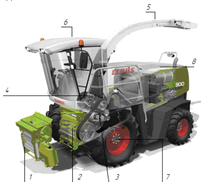
Рисунок 3 - Кормоуборочный комбайн «Jaguar» 900 серии фирмы «Claas»: 1 – питающий аппарат; 2 – измельчающий барабан; 3 – зернодробилка CornCracker»; 4 – ускоритель; 5 – силосопровод; 6 – кабина; 7 – ходовая часть; 8 – двигатель
