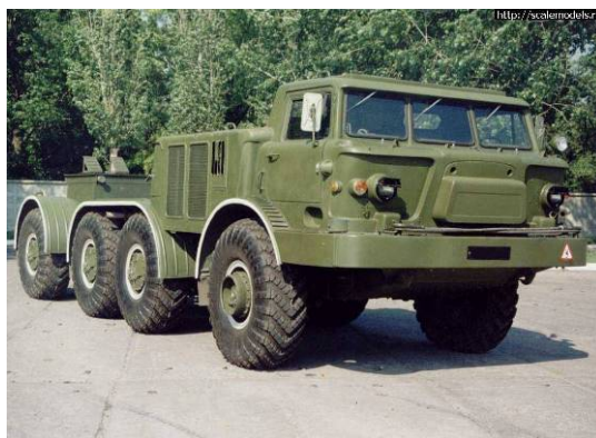
Рисунок 5 - Серийная колесная машина ЗИЛ-БАЗ-135 с кабиной, мотоотсеком и оперением из ПКМ
