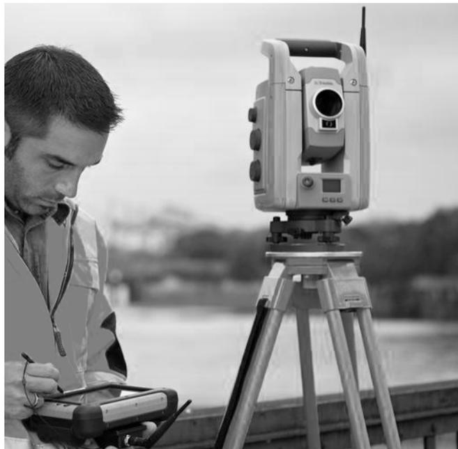
Рисунок 1 - Электронный роботизированный тахеометр
