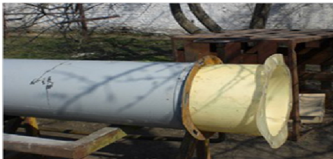
Рис. 1. Футерованные цельными полиуретановыми вставками с толщиной стенки 3.5
