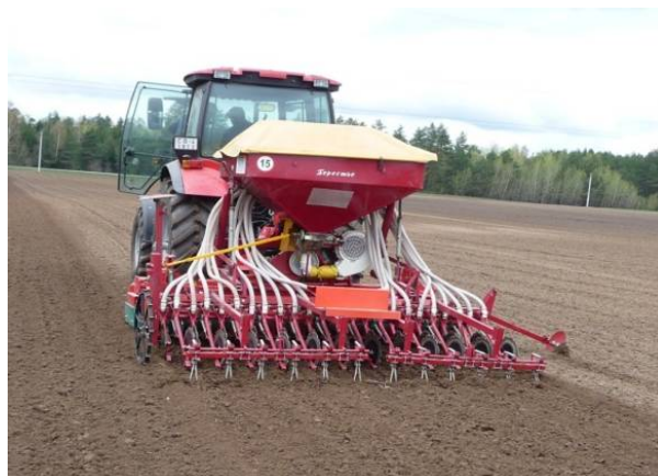
Рисунок 2 – Сеялка СПУ-4Д с установленными экспериментальными сошниками
