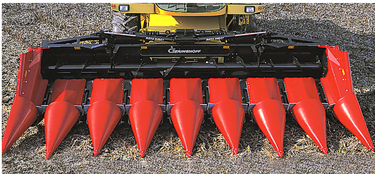
Рисунок 1 – Общий вид кукурузной приставки «Geringoff»
