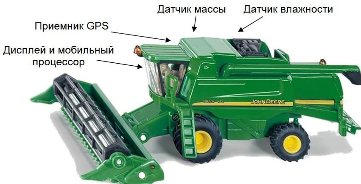
Рисунок 1 – Зерноуборочный комбайн «John Deere», оснащенный оборудованием для картирования урожайности
