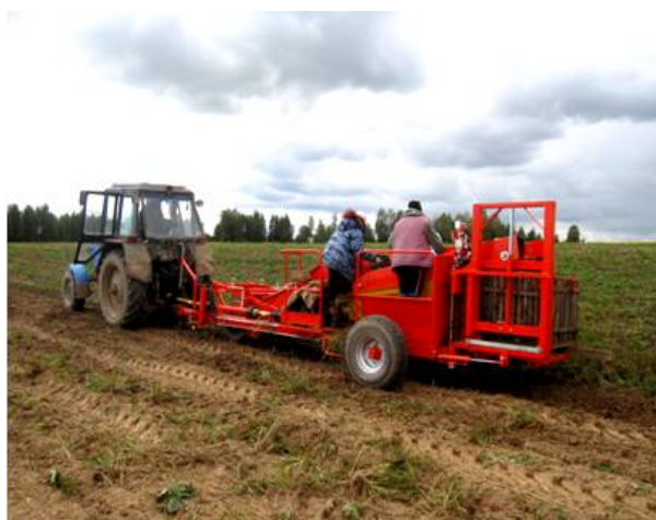
Рисунок 3 – Агрегат для уборки посадок миниклубней и клонов картофеля и топинамбура, изготовленный ВИМ
