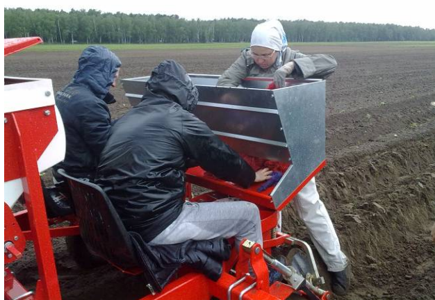
Рисунок 2 – Посадка клубней топинамбура сажалкой, изготовленной ФГБНУ ВИМ
