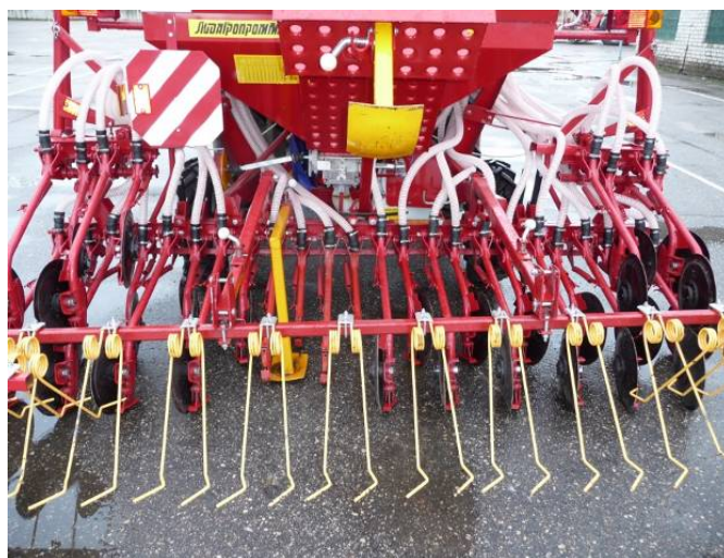
Рисунок 2 – Сеялка СПУ-4Д с установленными экспериментальными сошниками
