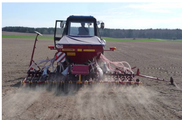
Рисунок 2 – Сеялка СПУ-4Д с установленными экспериментальными сошниками
