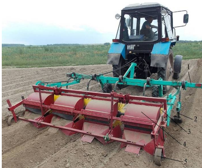
1 – рама с устройством для навески; 2 – рыхлительные и окучивающие лапы на чизельных стойках; 3 – щеточные барабаны; 4 – гребнеобразователь; 5 – копирующие колеса
