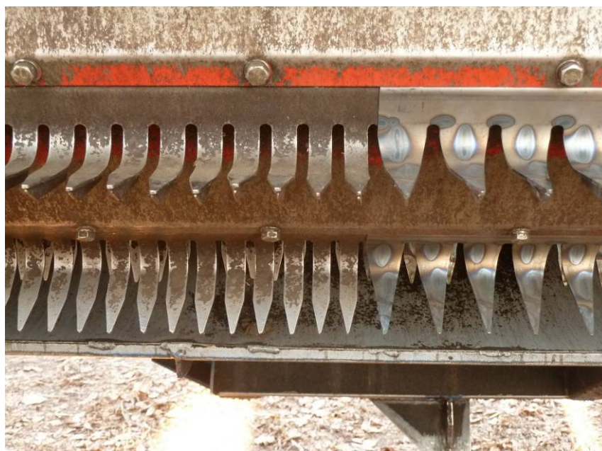
слева – стандартные; справа – модернизированные с большим раствором между зубьями
