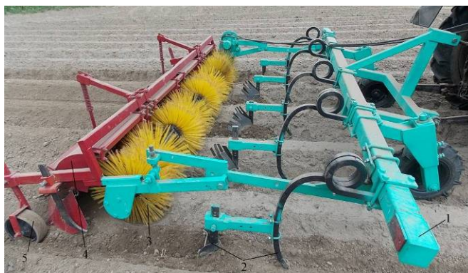
1 – рама с устройством для навески; 2 – рыхлительные и окучивающие лапы на чизельных стойках; 3 – гребнеобразователь; 4 – щеточные барабаны; 5 – копирующие колеса
