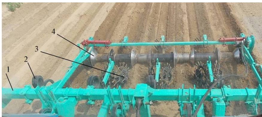
1 – рама с устройством для навески; 2 – рыхлительные и окучивающие лапы на чизельных стойках; 3 – ротационные боронки; 4 – грядкообразующий каток
