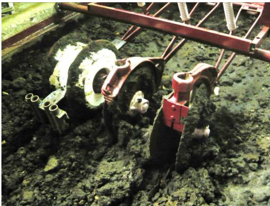
Рисунок 1 – Работа предлагаемых (слева) и традиционных (справа) бороздообразующих устройств в переувлажненной почве
