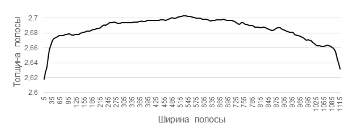
Рисунок 1 – Пример типичного поперечного профиля проката
