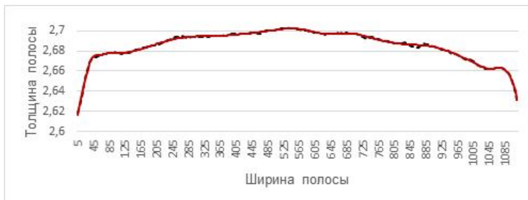
Рисунок 3 – Аппроксимация поперечного горячекатаного профиля кубическими B-сплайнами
