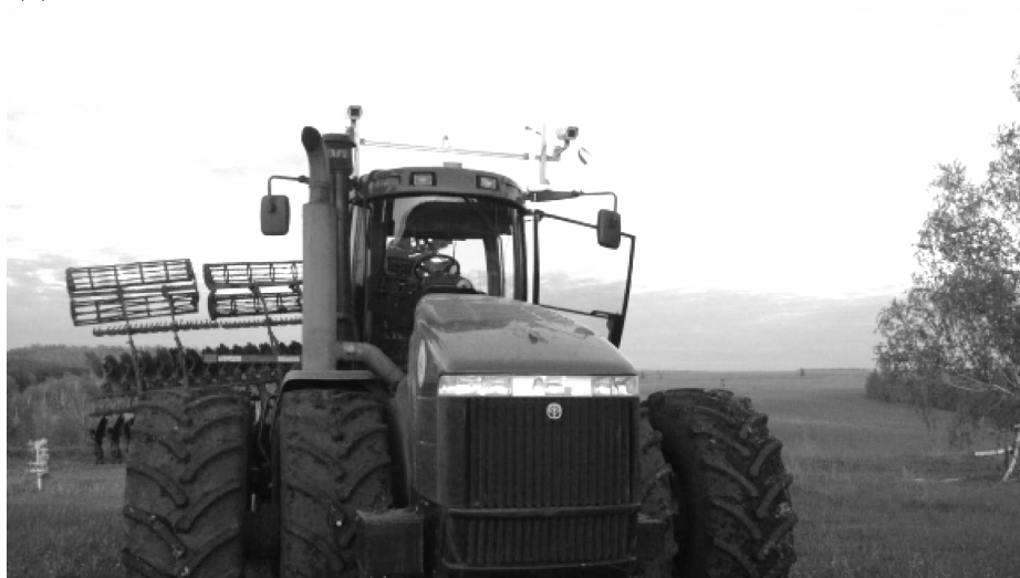
Рисунок 1 – Трактор-беспилотник компанией McConnel Roborower
