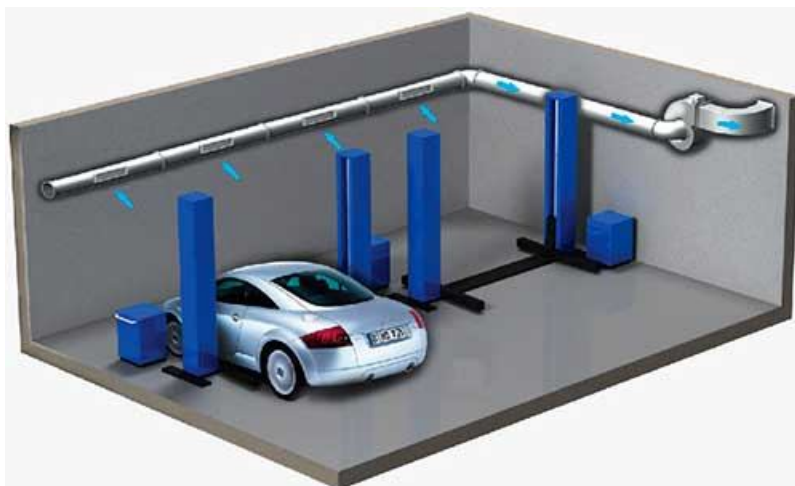
Рисунок 1 - Схема вентиляционной системы автосервиса
