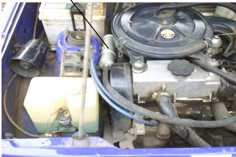
Рисунок 3 – Внешний вид статического смесителя-активатора моторного топлива установленного под капотом автомобиля ВАЗ-11113
