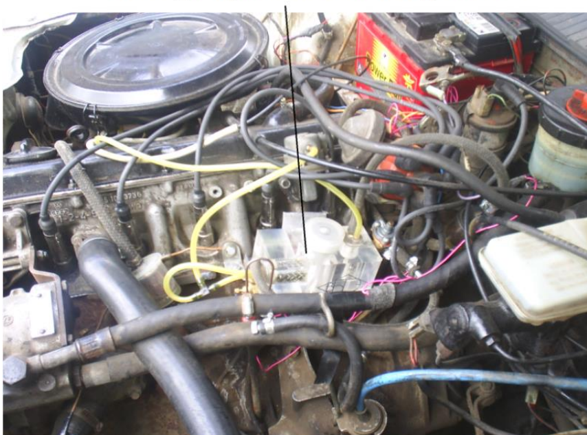
Рисунок 2 – Внешний вид компоновки блока для подачи ВТЭ на автомобиле AUDI-90 sport cupe
