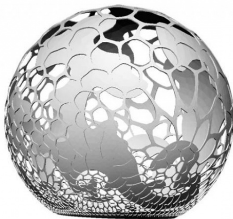
Рисунок 2 – Деталь созданная SLS-технологией
