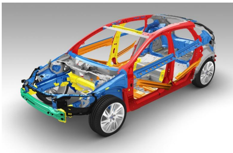
Рисунок 1 – Решетка безопасности легкового автомобиля (красным выделена капсула безопасности пассажиров автомобиля)
