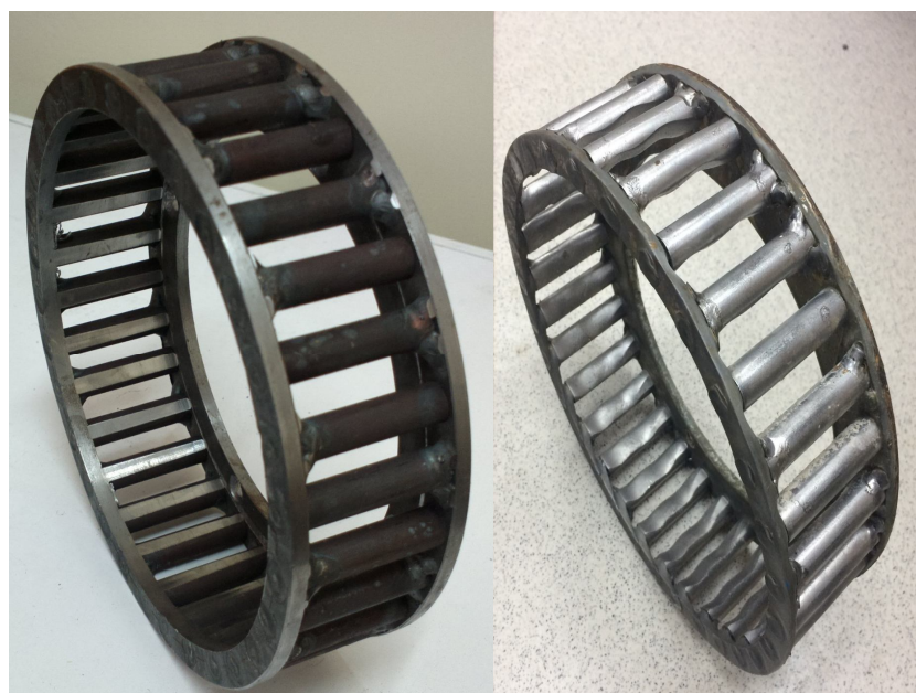
Рисунок 3 – Изготовленная решетка диспергатора и изношенная в процессе использования (абразивный износ)
