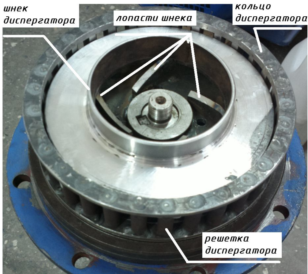
Рисунок 1 – Конструкция диспергатора для разрыва зерновки крахмала зерна на сахара используя ферменты
