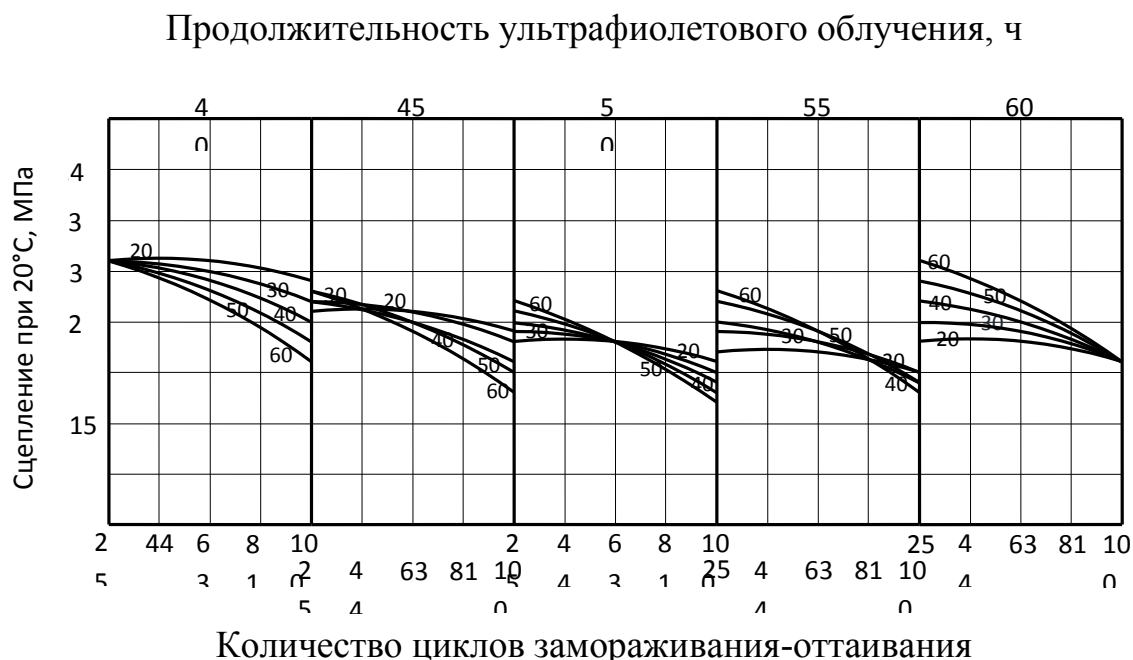
Рисунок 2 - Влияние комплексного воздействия виброввакуумного водонасыщения, ультрафиолетового облучения и ускоренного замораживания-оттаивания на сцепление асфальтобетона при температуре 20°С. Цифры на кривых – продолжительность виброввакуумного водонасыщения, ч
