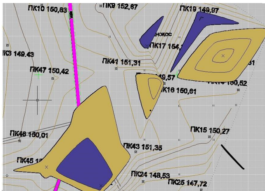
Рисунок 3 - Фрагмент цифровой 3D модели рельефа территории поверхности учебного полигона ВГАУ. Повышенные места рельефа отображаются светлыми тонами, пониженные — темными (числовые значения высотных отметок соответствуют точкам съемочного обоснования)
