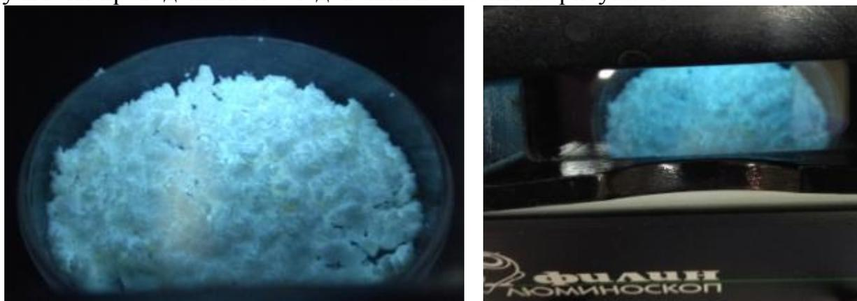
Рисунок 1 – Результаты люминесцентного анализа творога при свечении его ультрафиолетовыми лучами
