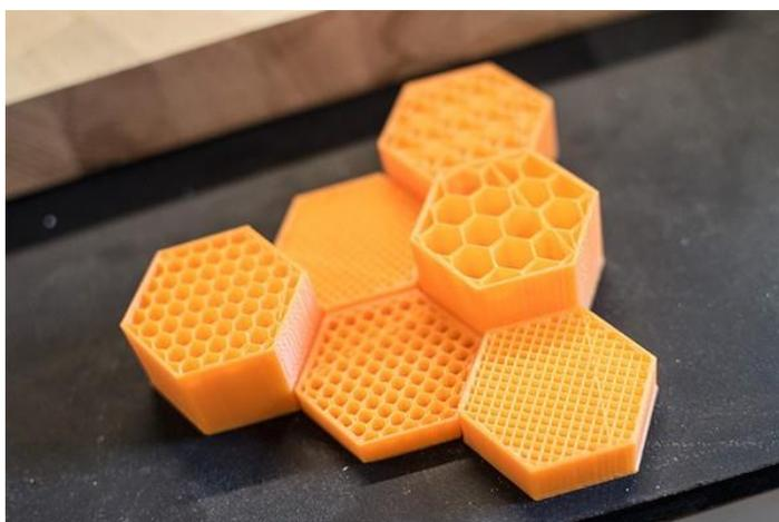
Рисунок 3 - Одинаковые внешне детали с разным процентом заполнения имеют разную прочность
