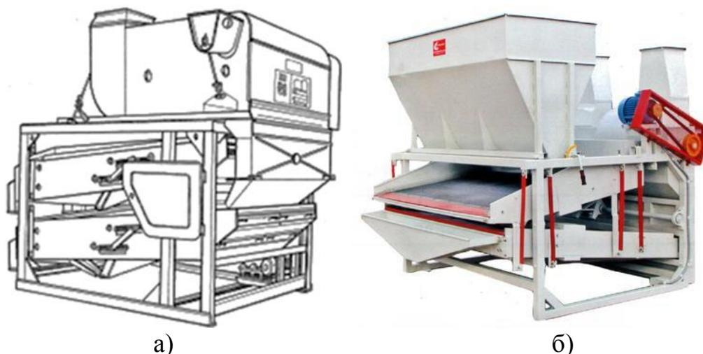
Рис.2 . Общий вид машин для первичной очистки зерна:
