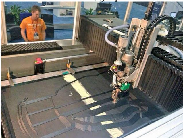
Рисунок 2 - 3D принтер печатает монокок автомобиля Strati [2]
