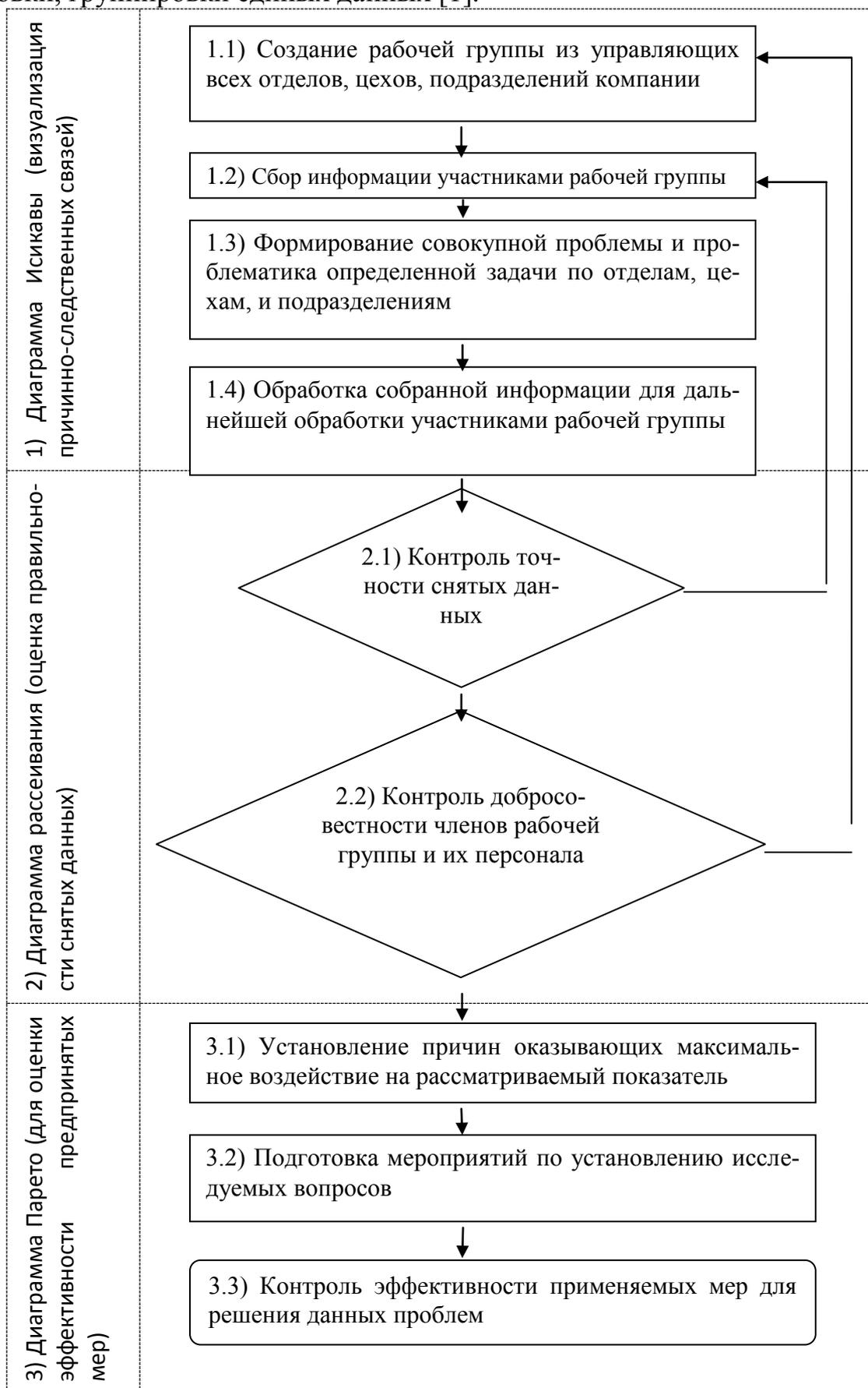
Схема предлагаемого метода анализа и управления процессом контроля качества на производстве
