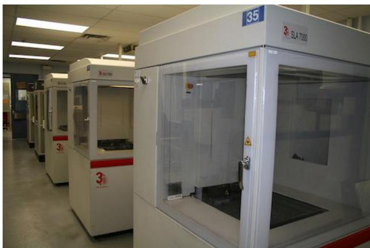
Рисунок 4 - Стереолитографические 3D-принтеры компании Форд в Дирборн-Хейгтс, штат Мичиган, США
