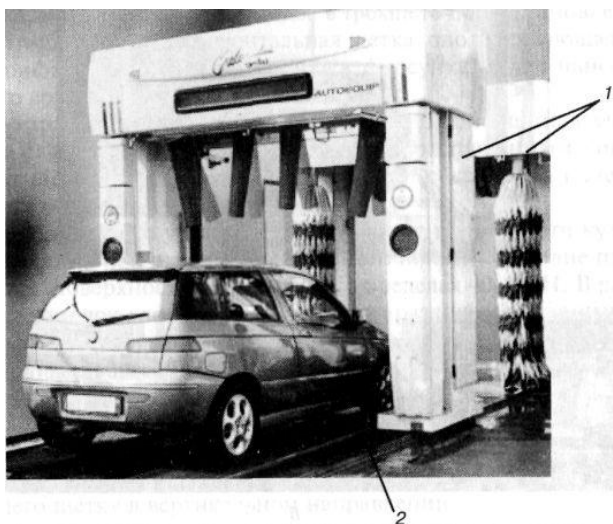
Рисунок 3 – Устройство струйной портальной мойки. 1 – П-образная рамка; 2 – направляющие портала.
