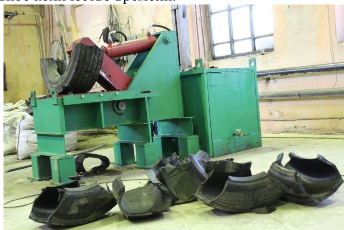
Рисунок 2 - Гидравлические ножницы для резки шин ГН-500.
