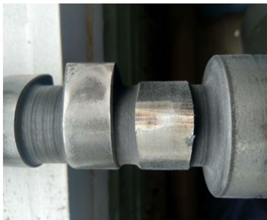
Рис. 3 – Кулачок с удаленным дефектным слоем
