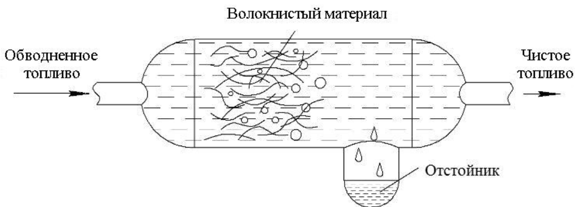
Рисунок 4-Схема работы коагулирующей перегородки фильтра-сепаратора
