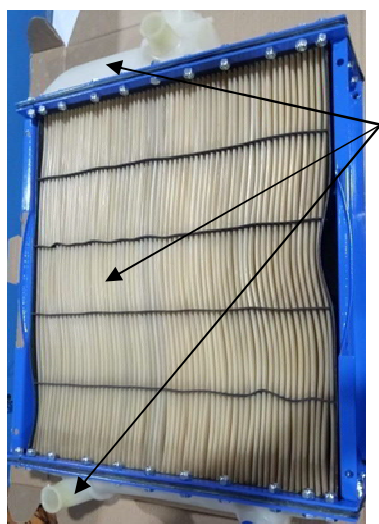
Рисунок 2 - Тракторный радиатор МТЗ-80 системы охлаждения двигателя с полиуретановой сердцевиной.
