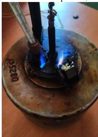
Рисунок 2 - Закрытый тигель для определения температуры вспышки смесей дизельного топлива с биодизелем (69°C)
