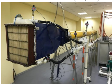
Рисунок 3 - Стендовые испытания опытного образца радиатора МТЗ-80 с полиуретановой сердцевинной.
