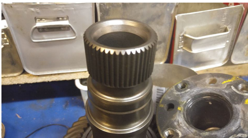
Рисунок 2 – Шлицевой вал после восстановления
