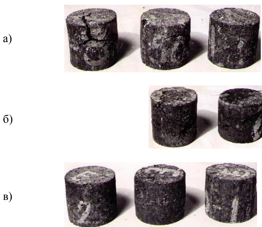
Рис. 3. Состояние асфальтобетона после 100 циклов замораживания-оттаивания со степенью распада конвертерного шлака: а) 5,4%; б) 1,7%; в) 1,27%
