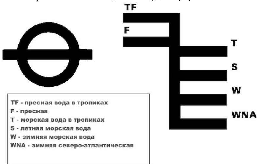
Рисунок 3 - Маркировка на борту подводной лодки (ватерлиния), указывающая степень погружения лодки в зависимости от типа воды.
